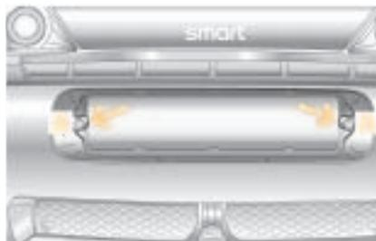
El sistema de ayuda de aparcamiento cuenta con dos sensores por ultrasonido (A) situados en el refuerzo de la matrícula trasera que controlan la parte posterior del vehículo cuando se desplaza lentamente marcha atrás (a velocidad de paso). Este sistema se activa automáticamente al arrancar el motor y acoplar la marcha atrás. Se oirá una señal acústica que indica que el sistema está listo para funcionar.
